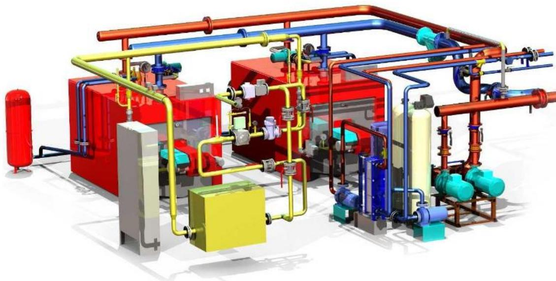
Рисунок 1. Принципиальная схема модульных котельных
